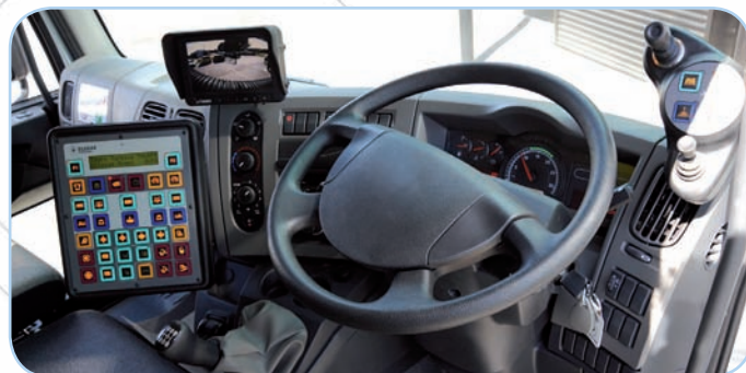
Panneau de contrôle et report de commandes
