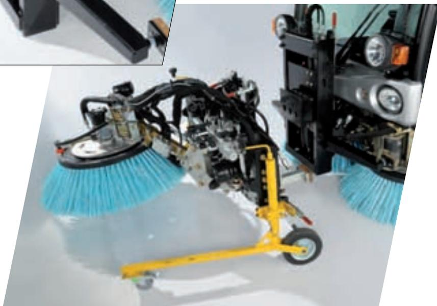
Rien ne résistera à cette balayeuse-outils prédisposée, en standard, à recevoir l'intégralité des outils de nettoyage et viabilité hivernale. Grâce à son système à démontage rapide, la pose et la dépose de vos outils seront un jeu d'enfant et vous permettront ainsi de demander encore plus
